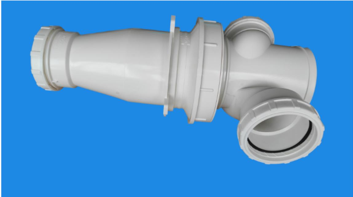
PP超静音排水管使用聚丙烯材料，三层共挤工艺制造。在噪音和耐高温性能上堪称优越，其排水量和使用寿命比一般的PVC排水管等排水管更加，在室内排水管中是推荐产品。能够有效应对室内排水的需求，尤其是解决传统PVC排水管的噪音问题，效果非常明显。上海隆塑管业生产的和财PP超静音排水管针对噪音问题，产品内外层选用聚丙烯材料，中间层采用经特殊改性的有一定粘弹性的聚丙烯材料，具有优良的吸收和减缓震动的动能，很好的降低了排水管道在使用过程中的噪音问题。上海区域设计很多沟槽排水。上海PP压盖式承插连接排水旋流降噪特殊单立管系统服务
