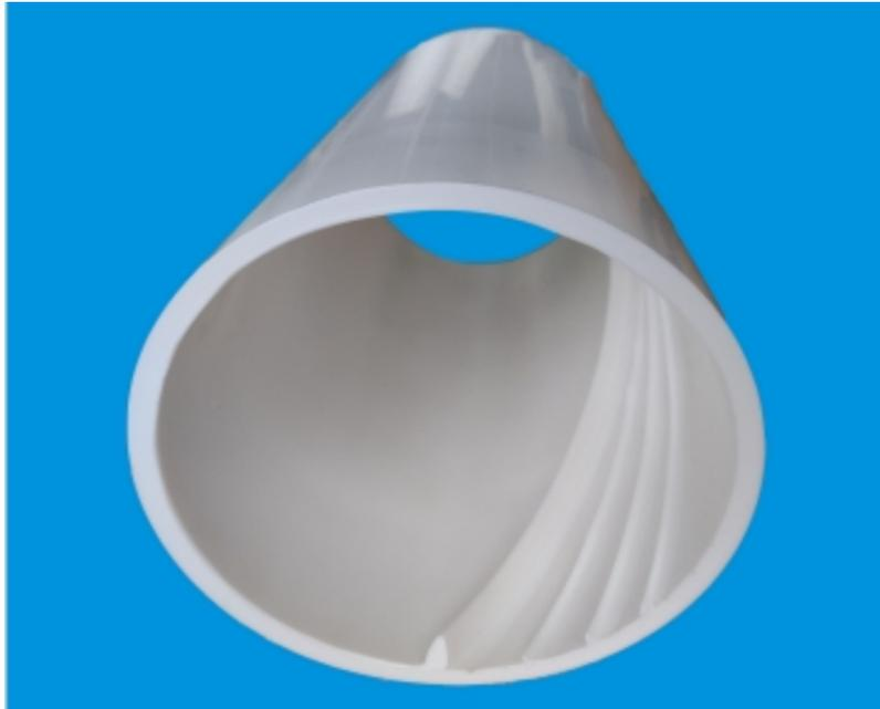
PP管是一种无毒、卫生、耐高温且可回收利用的管型，主要应用于建筑物室内冷热水供应系统，也适用于采暖系统。PP管的特点是不锈蚀、耐磨损、不结垢、减小振动和噪声、防冻裂（超过-20℃的低温下pp管产生冻裂，高温的工作环境只要超过70℃产生分解，使用温度在-20℃到70℃）、防结露，热损失少、安装简单、使用寿命长。连接方式有压盖式承插连接、螺盖式承插连接。隆塑管业在单扩、双扩等结构上设置更加科学，研发了三通带检查口管件、大口径管道螺盖式连接机构、可调节地漏等，给设计、施工单位及以后维修带来极大的方便。
